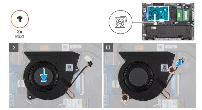
Figure 31. Installing the fan
