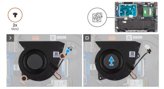
Figure 30. Removing the fan
